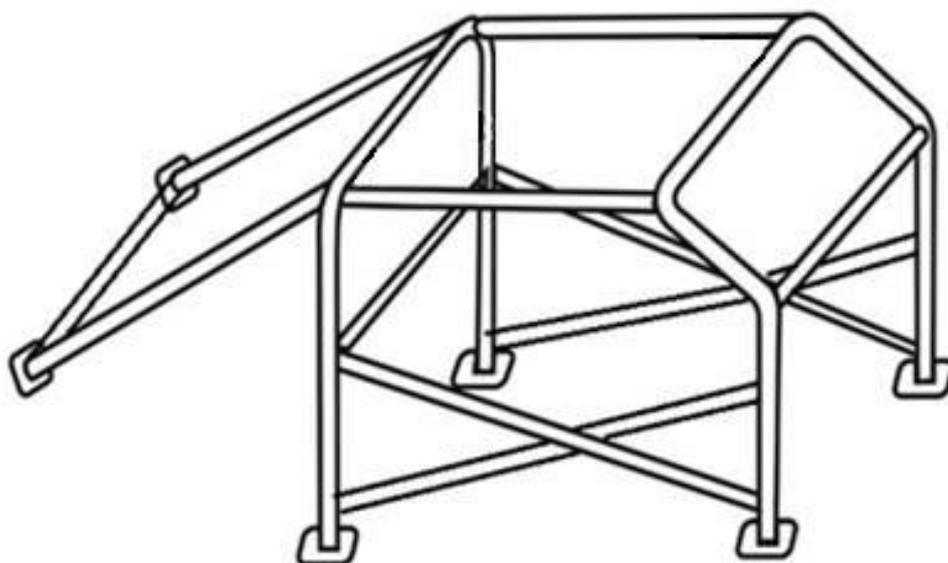
N4) Para veículos conversíveis o uso do santantonio é obrigatório, independente de tempo e velocidade obtidos. Este deve cobrir o piloto e ser do tipo “Funny Car Roll Cage”. Conforme figura abaixo:
