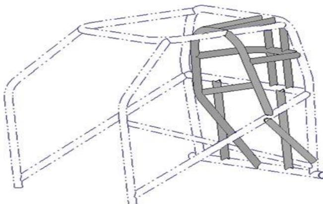
o) Fica liberado o uso de policarbonato em substituição ao vidro traseiro das picapes para possibilitar a colocação do quinto e sexto pontos de fixação do Sant Antonio.
