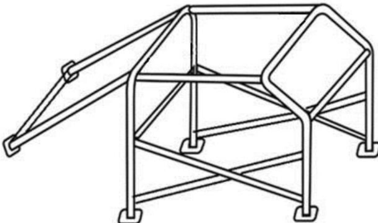
**N4)** Para veículos conversíveis o uso do santantonio é obrigatório, independente de tempo e velocidade obtidos. Este deve cobrir o piloto e ser do tipo “Funny Car Roll Cage”. Conforme figura abaixo:
