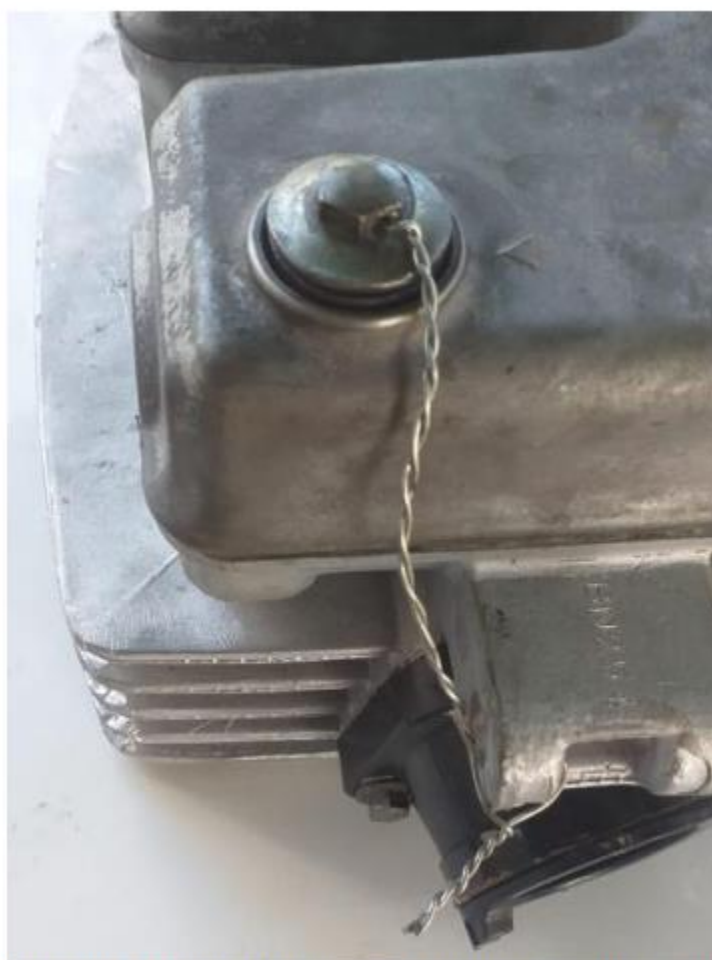
Imagem 3 – Detalhe furo passante no parafuso do cabeçote
