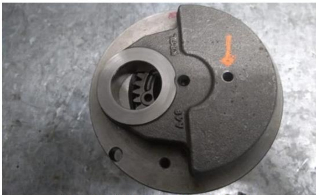
Imagem 5 - detalhe do furo na bolacha do virabrequim
