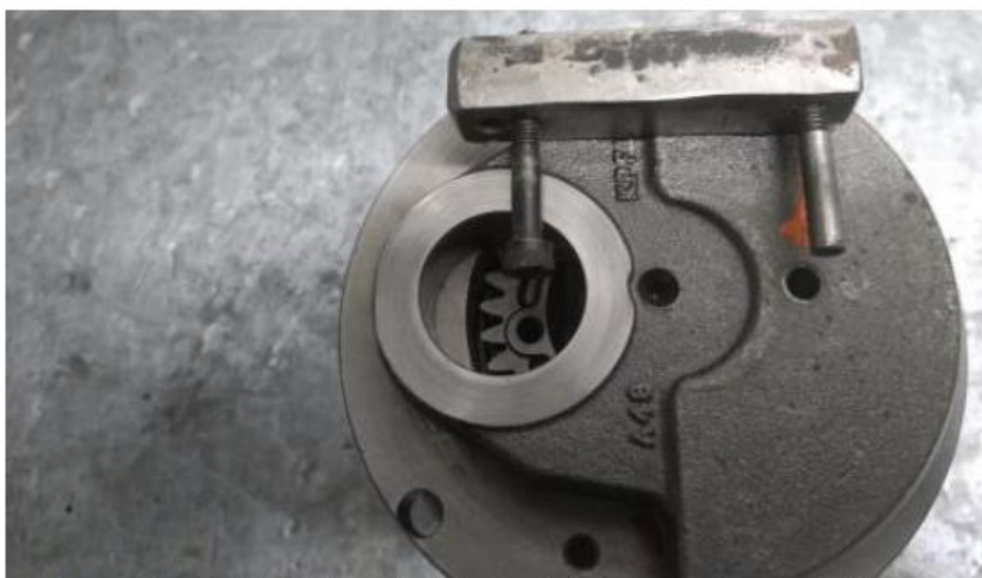
Imagem 6 - detalhe do furo na bolacha do virabrequim com ferramenta de saque
