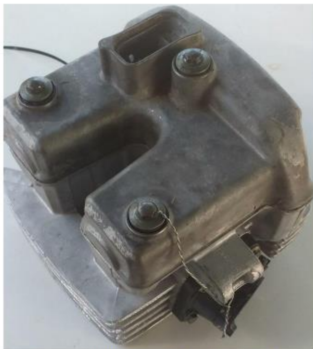
Imagem 2 – Detalhe furo passante no parafuso do cabeçote
