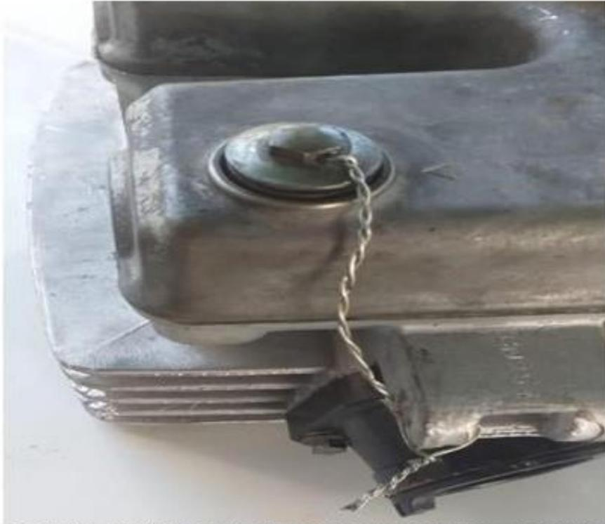
**Imagem 2 – Detalhe furo passante no parafuso do cabeçote**
