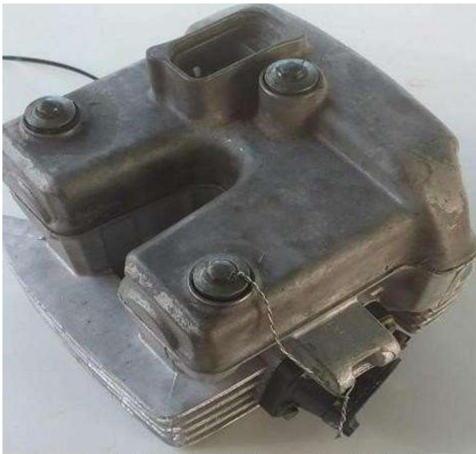
Imagem 1 – Detalhe furo passante no parafuso do cabeçote
