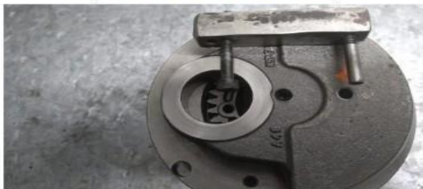
Imagem 4 – detalhe do furo na bolacha do virabrequim com ferramenta de saque
