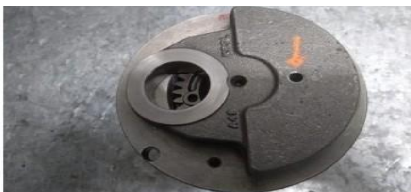
Imagem 3 – detalhe do furo na bolacha do virabrequim
